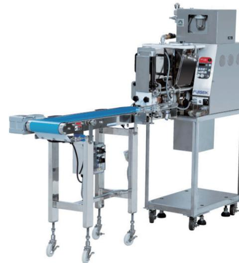
粘度の高い商品でもスクリュース式で押し出し可能。新商品の開発や小ロット生産の製造にもお勧め。コンパクト設計、スパナ・ドライバー等の工具を使わない分解・組立で洗浄も簡単。豊富なダイスでオリジナリティー溢れる商品製造が可能。またお客様オリジナルの形状製造の可能。ジビエを活用したオリジナルペットフード製造もお任せ。
